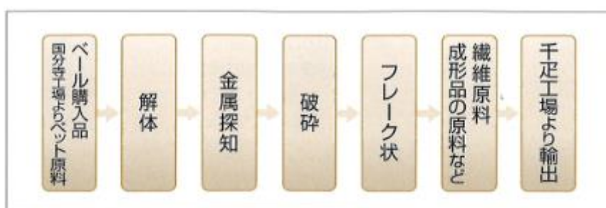
図表5 PETボトルフレーク化処理ワークフロー
