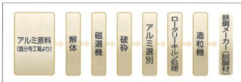
図表6 アルミ原料造粒化ワークフロー
